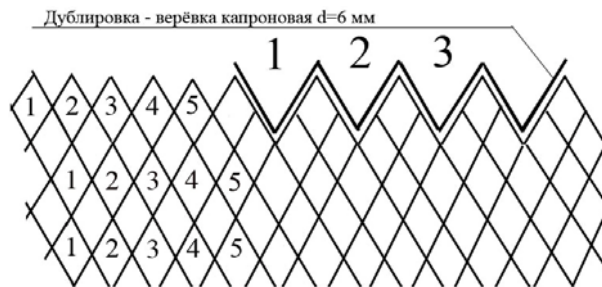
Рис. 5. Соединение канатной и делевой частей трала (пять ячей дели забирается в шворочный шов) Fig. 5. Join rope and net parts of the trawl (five meshes of net are withdrawn in seam)
